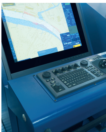
URZĄDZENIE DO AUTOMATYCZNEGO WYKONYWANIA NAKRESÓW RADAROWYCH
